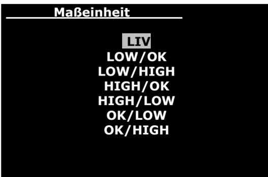
In diesem Bildschirm kann die Bildschirmanzeige der Niveausteuerng spezifiziert werden. Die Grundeinstellung LIV ist neutral. LIV 1 bedeutet niedrig (unterhalb des Schwimmerschalters), LIV 2 hoch (oberhalb des Schwimmerschalters). Die Anzeige kann je nach Bedarf abgeändert werden.
