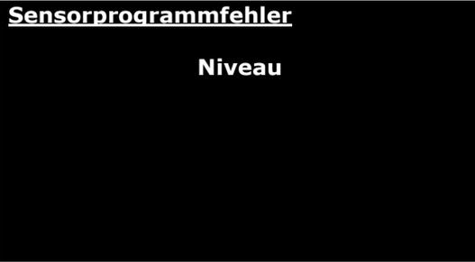
Wenn die Niveausonde die Steckdose aktiviert und die angeschlossene Pumpe es nicht schafft, den gewünschten Zustand in der eingegebenen Maximumzeit wieder herzustellen, wird der Ausgang blockiert. Es erscheint die Meldung „Sensorprogrammfehler“ und ein akustischer Alarm. Es liegt eine Störung vor. Der Ausgang muss manuell wieder freigeschaltet werden. Dazu wird im Hauptmenü das Niveauprogramm aufgerufen. Im Niveauprogramm steht jetzt die Zeile „Prog.“ Entblocken“. Diese wird mit Enter bestätigt.
