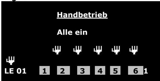
Jetzt sind die Steckdosen manuell eingeschaltet. Auf der Stellung „alle wiederherstellen“ verschwinden die Handsymbole.
